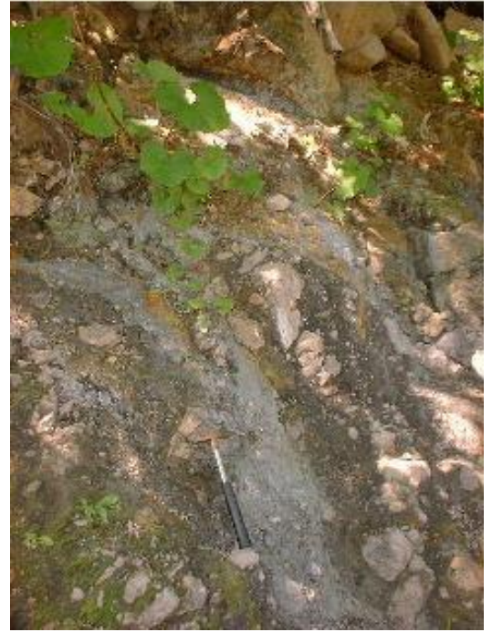
典型的な地滑り地形がみられるダム予定地左岸（↑） 堤体部で破碎帯が水を含んでほとんど粘土状になっている（→）
